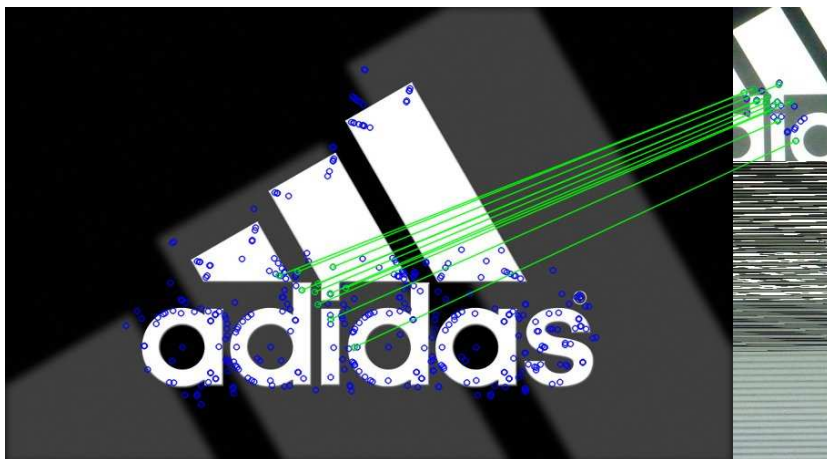
Σχήμα 4.13: Αντιστοίχιση με τη φωτογραφία 4.7, κοινά σημεία: 11 - προσοχή στο γεγονός ότι λόγω του περιορισμένου bounding box όπως καθορίστηκε από το cnrfile της εικόνας, βρίσκονται σαφώς λιγότερα σημεία
