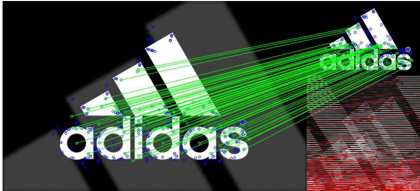
Σχήμα 4.16: Αντιστοίχιση με το λογότυπο 4.8, κοινά σημεία: 71 - ικανοποιητικά αρκετά κοινά σημεία παρόλο που πρόκειται για διαφορετική ουσιαστικά εικόνα και όχι για παραλλαγή της αρχικής με αλλοιώσεις που οφείλονται στη γωνία λήψης και το θόρυβο της φωτογραφίας όπως έγινε στις προηγούμενες εικόνες - αυτό είναι γενικά θετικό γεγονός καθώς βλέπουμε ότι το σύστημα είναι ανθεκτικό και σε βασικές παραλλαγές της εικόνας
