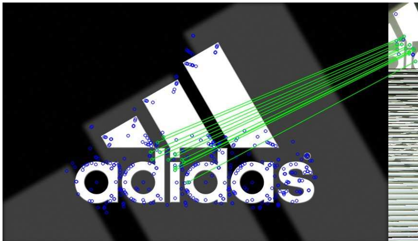
Σχήμα 4.15: Αντιστοίχιση με τη φωτογραφία 4.5, κοινά σημεία: 12 - ακόμα πιο μικρο bounding box
