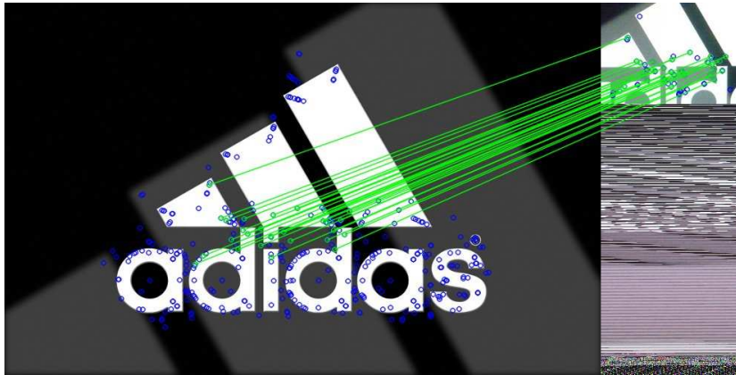
Σχήμα 4.14: Αντιστοίχιση με τη φωτογραφία 4.3, κοινά σημεία: 27 - ισχύει ότι και στην προηγούμενη σύγκριση για το περιορισμένο bounding box
