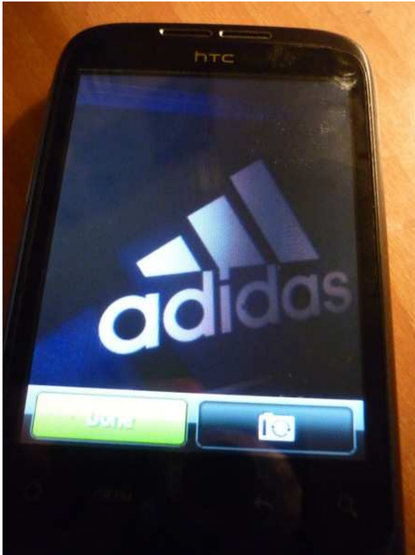
Σχήμα 4.23: Η φωτογραφία που βγάλαμε με την κάμερα του κινητού θα περιέχει αρκετή αλλοίωση, τόσο ως προς τη γωνία λήψης όσο και από το φωτισμό και άλλες παραμορφώσεις θορύβου.
